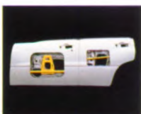
Stalen balken in de portieren
