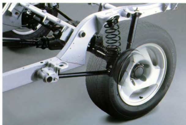
Multi-link schroefveer met starre as achter
