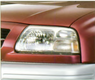
Multi-reflecterende halogeen koplampen
