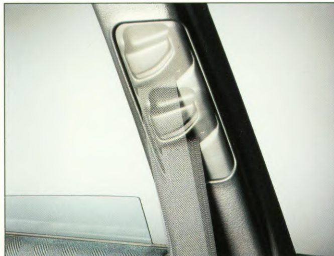
In hoogte verstelbare (4-/5 d) veiligheidsgordels zorgen voor een optimaal draagcomfort en zekerheid.
