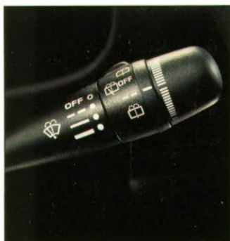
Variable intervalschakelaar op de ruitwissers (v.a. LX).
