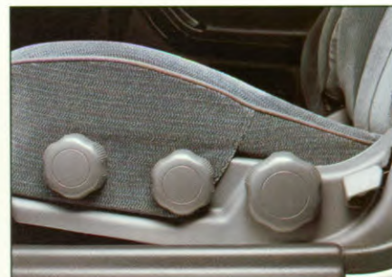
Uw ideale zitpositie is comfortabel in te stellen. Bestuurdersstoel: vóór- en achterzijde in hoogte verstelbaar (v.a. LX). Traploos verstelbare rugleuningen vóór.
