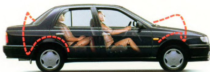
De beschermende kooiconstructie en kreukelzones zijn het resultaat van uitgebreide botsproeven.
