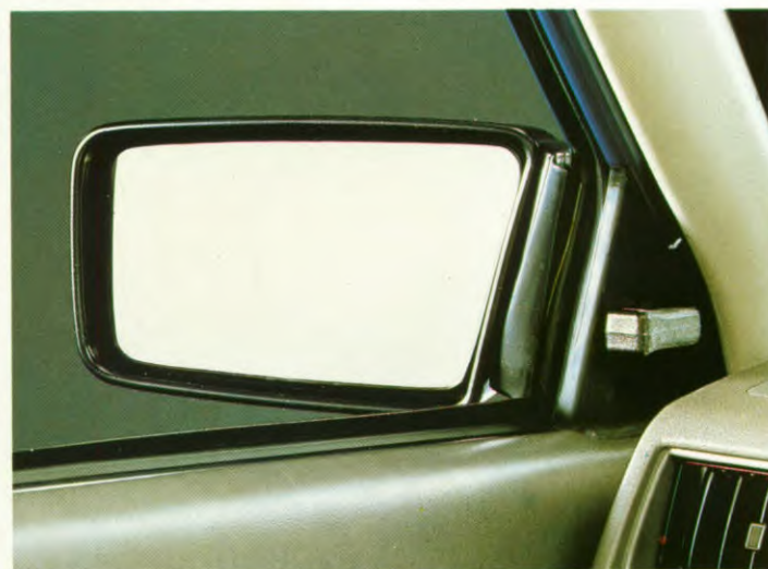
Van binnenuit verstelbare buitenspiegel (GL).
