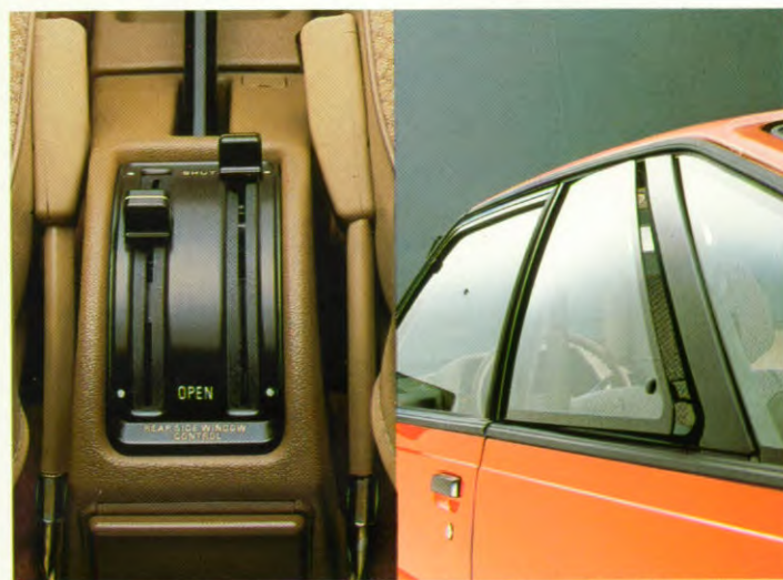
Achterzijruiten vanaf tunnelconsole te bedienen (Coupé).
