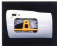
Stalen balken in de portieren
