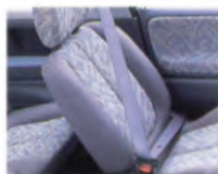
Driepuntsveiligheidsgordel met gordelspanner voor
