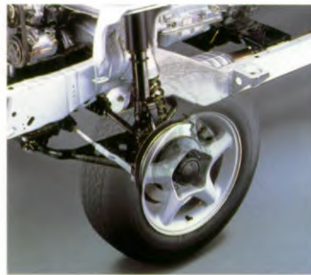
MacPherson voorwielophanging met schroefveren
