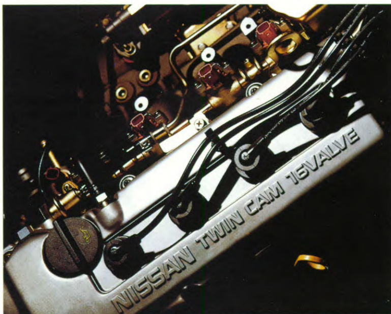
1.6 liter, 16 kleppen, DOHC. Koppel: 131 Nm bij 3.600 tpm. 5-bak
