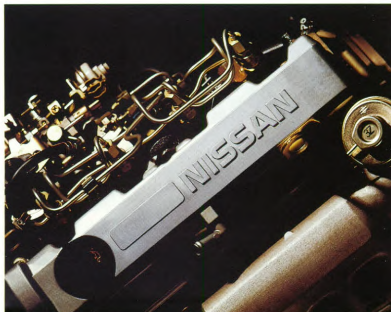
2.0 liter diesel. Koppel: 127 Nm bij 2.400 tpm. 5-bak
