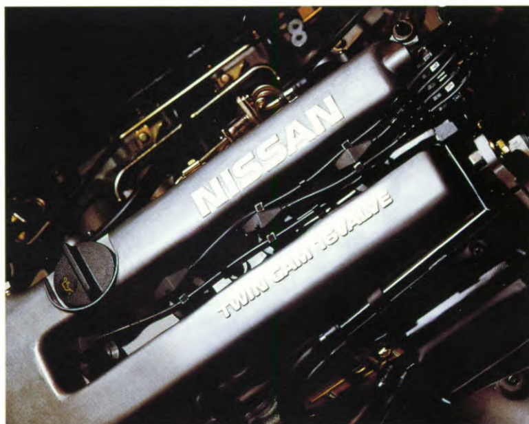
2.0 liter, 16 kleppen, DOHC, Koppel: 169 Nm bij 4.800 tpm. 5-bak.
