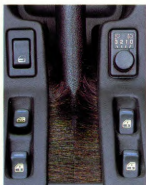
Elektrisch bedienbare ramen met handig geplaatste bediening op de middenconsole en de armsteun van de bestuurder vanaf de SLX.
