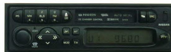
Radio/cassettespeler CK936 met hoog uitgangsvermogen (4x25W), "Full logic" cassettemechanisme, telefoonmutesysteem, CD-wisselaarbesturing met random zoekfunctie, RDS EON met PTY, aansluiting op NATS III startblokkering, afneembaar bedieningspaneel en antidiefstalcode.
