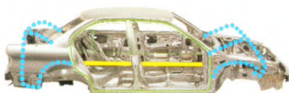
Schokabsorberende kreukelzones voor en achter.
