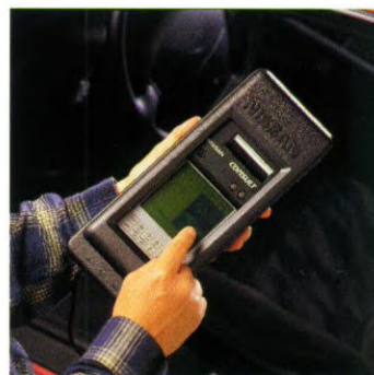
Snelle diagnose. Het motormanagementsysteem is snel en eenvoudig te controleren met behulp van een Consult, een handzame computer die de onderhoudstijd tot het absolute minimum terugbrengt.
