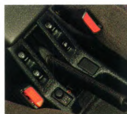
Elektrisch bediende ramen.
