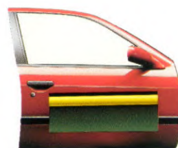
Alle portieren zijn voorzien van veiligheidsbalken.
