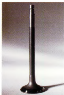
Voor een snelle warmteafvoer zijn de kleppen van de 2.0 GT motor met natrium gevuld.
