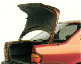
Ruimtebesparende kofferklepscharnieren op 4-deurs.
