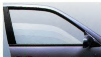
Elektrisch bediende ramen v.a. SLX
