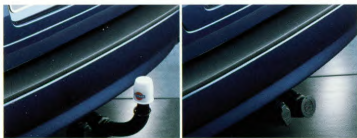
Trekhaak met afneembare kogelkoppeling en kabelset.
