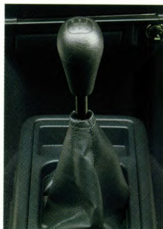
5-bak standaard Tegen meerprijs leverbaar: automatische 4-versnellingsbak met blokkeerinrichting op de koppelomvormer (lock-up) waarvan de 4e versnelling een elektrisch uitschakelbare overdrive is.
