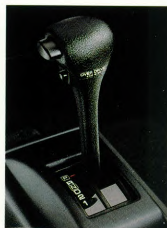
5-bak standaard Tegen meerprijs leverbaar: automatische 4-versnellingsbak met blokkeerinrichting op de koppelomvormer (lock-up) waarvan de 4e versnelling een elektrisch uitschakelbare overdrive is.
