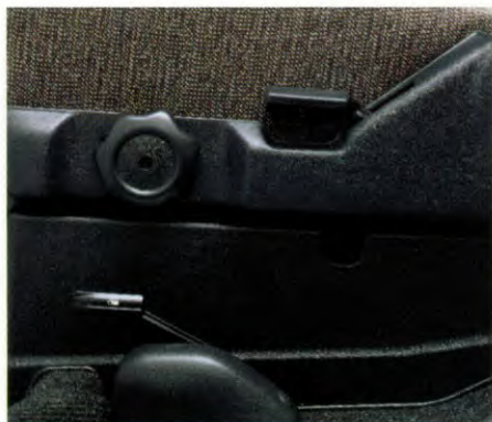
Kantelmechanisme op bestuurdersstoel
