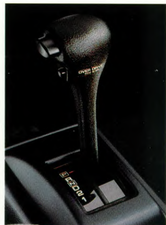
5-bak standaard Tegen meerprijs leverbaar: automatische 4-versnellingsbak met blokkeerinrichting op de koppelmvormer (lock-up) waarvan de 4e versnelling een elektrisch uitschakelbare overdrive is.
