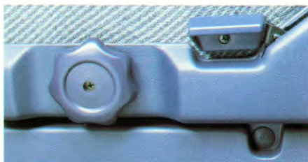
Kantelmechanisme op bestuurdersstoel.
