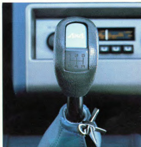
Elektrisch inschakelbare vierwielaandrijving via een knop op de versnellingspook. Indicatie-lampje voor ingeschakelde vierwielaandrijving.
