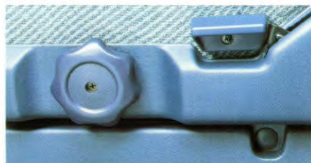
Kantelmechanisme op bestuurdersstoel.
