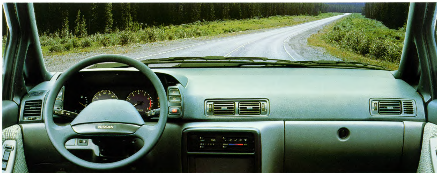
Dashbord met analoge meters, toerenteller, digitale quartzklok. Gelaagde voorruit, getint glas rondom.
