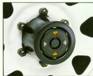
Vrijloopenaven op de vooras welke zowel automatisch als met de hand kunnen worden ingeschakeld.
