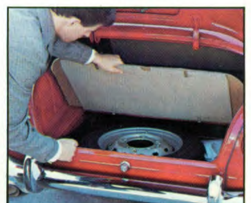
reservewiel en -gereedschap in aparte ruimte.
