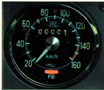
rood verklikerslicht bij defekt remsysteem
