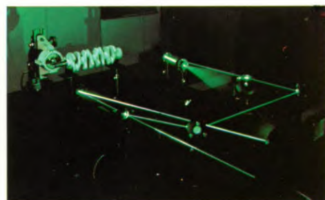
Trillingen worden gemeten met gebruikmaking van holografie: nieuwe technieken in dienst van kwaliteit, veiligheid en comfort.
