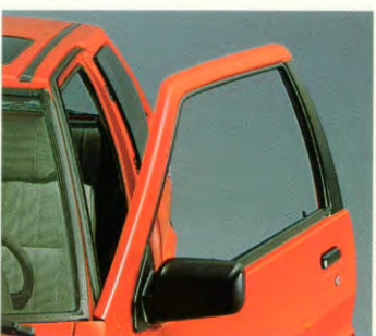
Tot in het dak doorlopende portieren.
