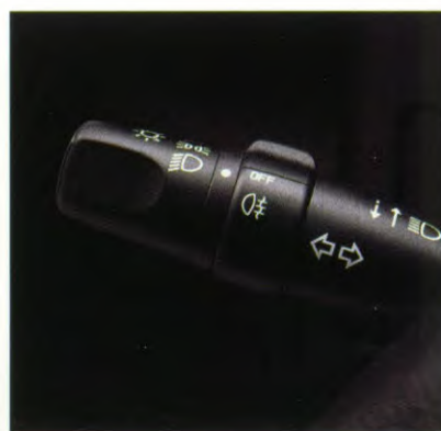
Geïntegreerde mistlampschakelaar (mistlamp gaat automatisch uit bij uitschakeling verlichting).
