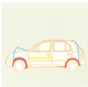
Veiligheidsbalken in de portieren en computerberekende kreukelzones voor en achter.
