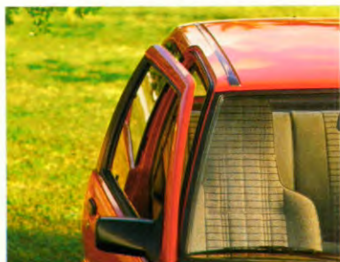
Portieren in het dak doorgetrokken.
