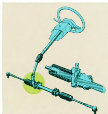
Veiligheids-stuurkolom met stuurslot. Tandheugel-stuurinrichting.
