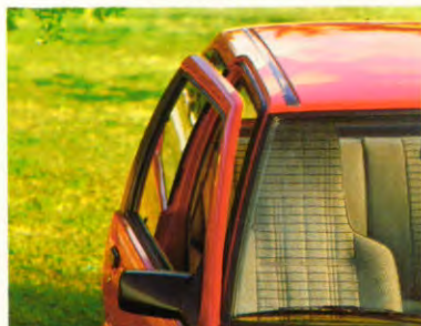
Portieren in het dak doorgetrokken.
