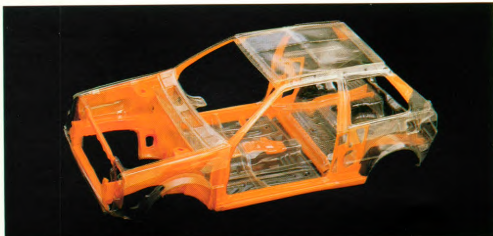
Verzinkt plaatstaal op de meest kwetsbare plaatsen.
