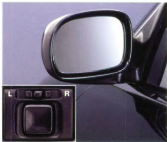
De elektrisch bedienbare buitenspiegels kunnen nauwkeurig worden afgesteld.
