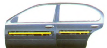
Veiligheidsbalken in de deuren.
