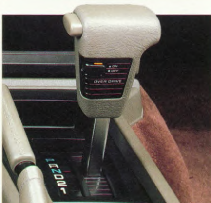
Automatische 4-versnellingsbak met elektrisch inschakelbare overdrive (standaard op SGX) tegen meerprijs leverbaar op SLX.
