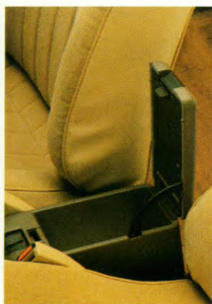
Tunnelconsole met opbergvak (GL).
