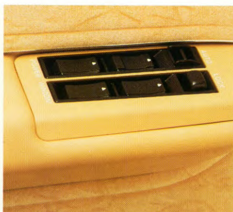
Elektrisch bedienbare ramen vóór en achter. Bedieningspaneel bij bestuurder met extra tipcontact, waarmee de bestuurder zijn raam in één keer geheel kan openen of sluiten.
