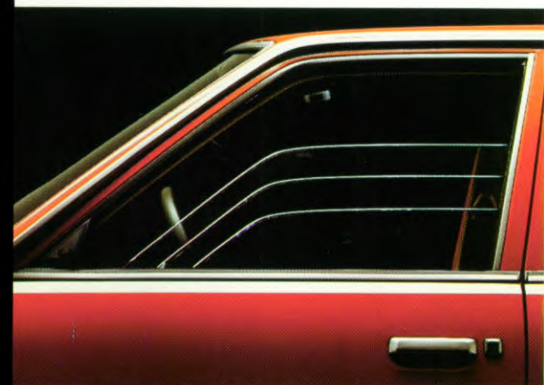
Elektrisch bedienbare ramen vóór en achter. Bedieningspaneel bij bestuurder met extra tipcontact, waarmee de bestuurder zijn raam in één keer geheel kan openen of sluiten.
