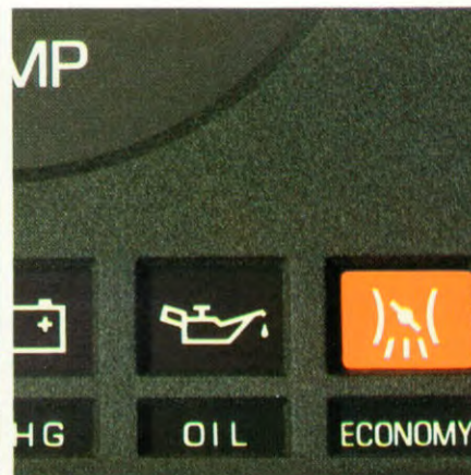
emotor levert 83 kW(113 DIN pk). 5-Versnellingsbak op 2400 en 2800 Diesel. Automaat op 2400. Economy indicatielampje voor zuiniger rijden (2400 modellen).
