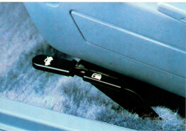
Ontgrendeling van koffer- en benzinetankklep van binnen uit.
