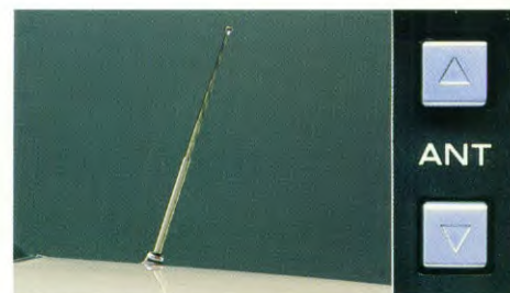
Elektrisch bedienbare antenne (vanaf SLX).
