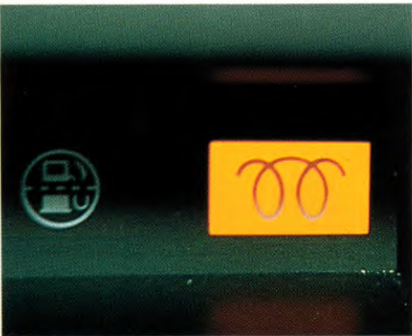
Voorgloeitijd Diesel nog geen 4 seconden.
