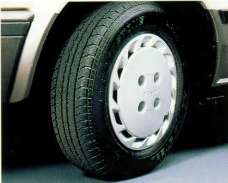
Brede staalgordel radiaalbanden. SLX: 185/70 SR 14.
