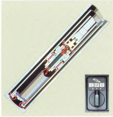
Elektronisch regelbare schokdemperwerking instelbaar in 3 gradaties (SGX Turbo).
