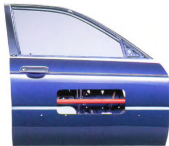
De portieren zijn standaard voorzien van stalen balken.
