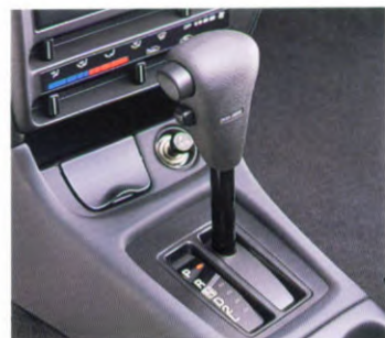
Een viertraps automatische transmissie met lock-up, leverbaar op de modellen met 1,6 liter motor, heeft drie schakelprogramma's om een gunstig verbruik te koppelen aan optimale prestaties.
