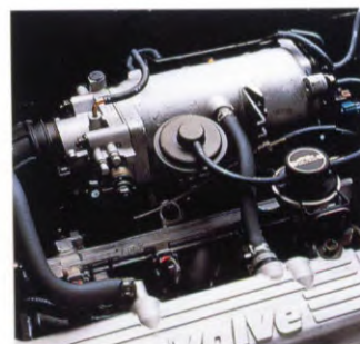
Dankzij multi-point brandstofinjectie beschikt de Baleno over veel vermogen en trekkracht.
