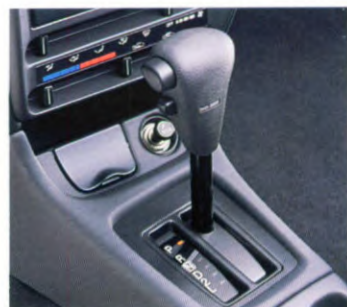
Een viertraps automatische transmissie met lock-up, leverbaar op de modellen met 1,6 liter motor, heeft drie schakelprogramma's om een gunstig verbruik te koppelen aan optimale prestaties.
