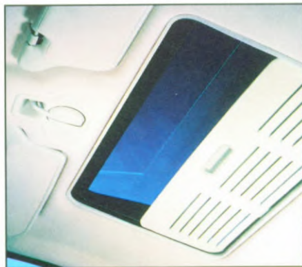
4. Schuif/kanteldak met jalouzie (MG Montego Turbo).
