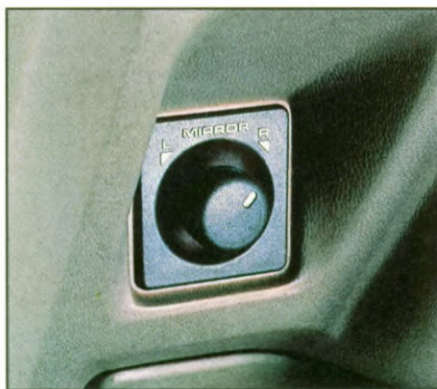
1. Electrisch, van binnenuit te bedienen buitenspiegelverstelling (vanaf Austin Montego Mayfair).
