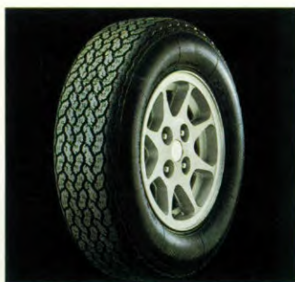
195/70 VR-14 staalgordel tubeless radiaalband op lichtmetalen 6J-14 velg.
