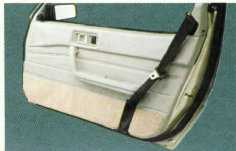
De veiligheidsgordels voorin zijn zowel van boven als van onder aan het portier bevestigd.
