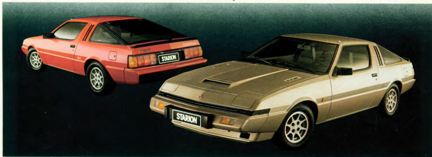
195/70 VR-14 staalgordel tubeless radiaalband op lichtmetalen 6J-14 velg.
