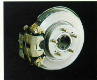
Inwendig geventileerde remschijven achter
