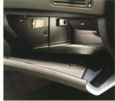
Cooler Extra: Bei Fahrzeugen mit Klimaanlage kann das Handschuhfach gekühlt werden.
