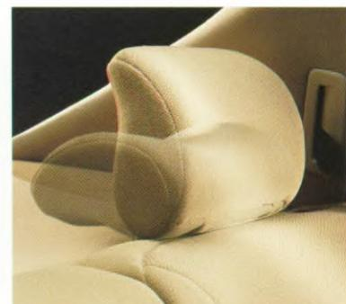
*Für eine bessere Sicht nach hinten lassen sich die Kopfstützen im Fond verstellen.*
