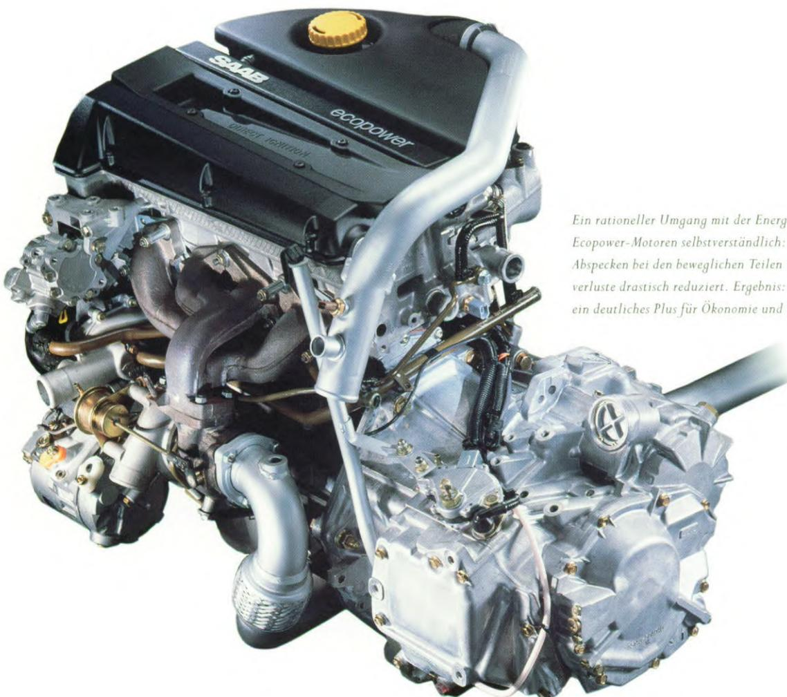
*Ein rationeller Umgang mit der Energie ist für die neuen Ecopower-Motoren selbstverständlich: Durch konsequentes Abspecken bei den beweglichen Teilen wurden die Reibungsverluste drastisch reduziert. Ergebnis: Mehr Leistung und ein deutliches Plus für Ökonomie und Ökologie.*
