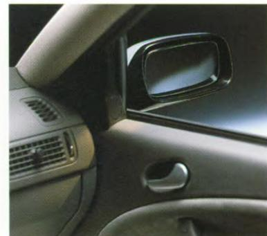
Elektrisch anklappbarer Außenspiegel auf der Beifahrerseite mit automatischer Rückstellung. Nimmt beim Einparken die Bordsteinkante ins Visier.
