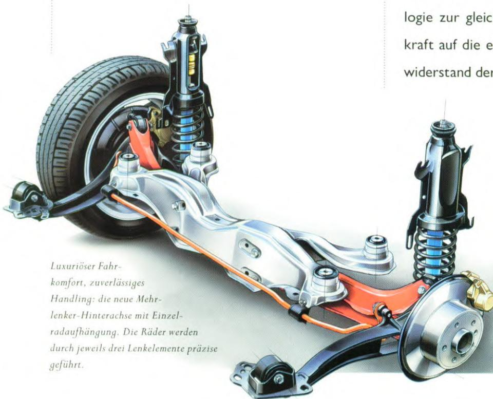
Luxuriöser Fahrkomfort, zuverlässiges Handling: die neue Mehrlenker-Hinterachse mit Einzerradaufhängung. Die Räder werden durch jeweils drei Lenkelemente präzise geführt.
