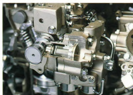
Deze pomp zorgt ervoor dat de benzine onder zeer hoge druk direct in de cilinder wordt gespoten.
