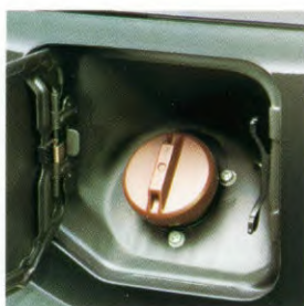
Een speciale plastic schroefdop verkleint bij aanrijdingen het risico van brandstoflekkage en daarmee het gevaar van brand.
