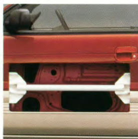
Stalen stangen in de portieren minimaliseren vervormingen bij frontale en zijwaartse aanrijdingen.
