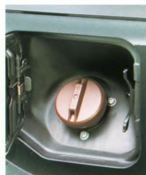
Een speciale plastic schroefdop verkleint bij aanrijdingen het risico van brandstoflekkage en daarmee het gevaar van brand.
