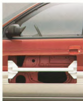
Stalen stangen in de portieren minimaliseren vervormingen bij frontale en zijwaartse aanrijdingen.
