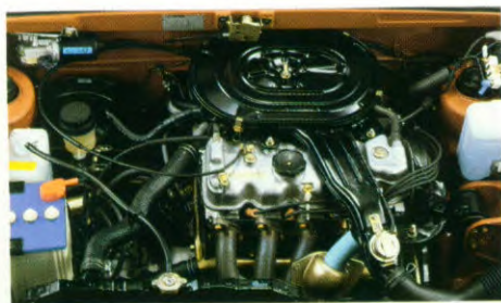
Voorin ligt het vier-cylinder 1755 cc sterke motorblok.
