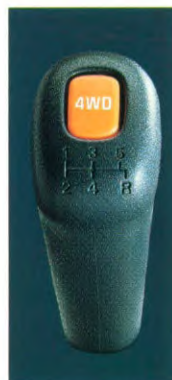
Schakelaar 4WD aandrijving.
