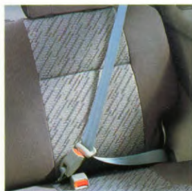
De voorstoelen zijn voorzien van 3-punts ELR veiligheidsgordels. De gordels achter hebben bovendien ALR.
