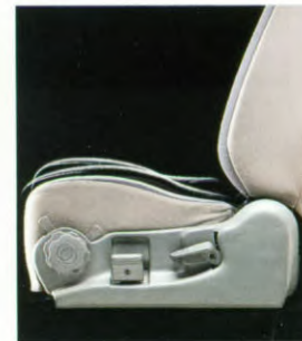
De zitting van de bestuurdersstoel is zowel aan de voor- als aan de achterzijde kantelbaar voor een perfecte zithouding.
