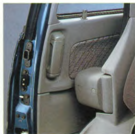
Een extra veiligheidssysteem voorkomt dat de schuifdeur onverwachts dichtglijdt. (Bij bijvoorbeeld het parkeren op een helling.)
