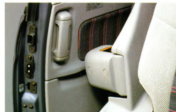
Een dubbel sluitsysteem houdt de schuifdeur gesloten bij een botsing.
