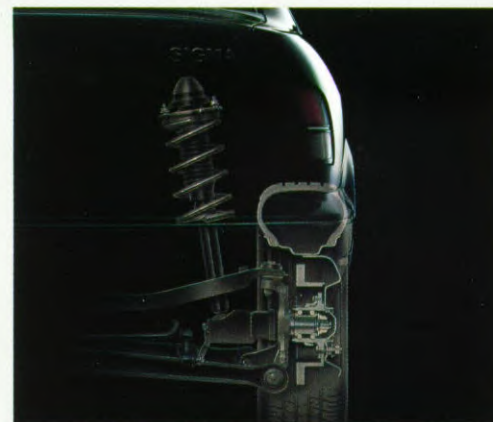
De Multi-link achterwiellophanging garandeert een maximum aan stabiliteit en wegligging tijdens remmen, accelereren en in de bochten.
