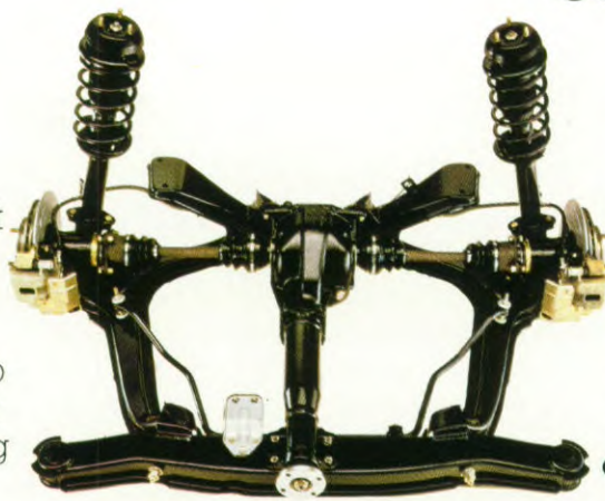
Onafhankelijke achterwielophanging met schroefveren en gasgevulde schokbrekers (vanaf 2000 GSR).
