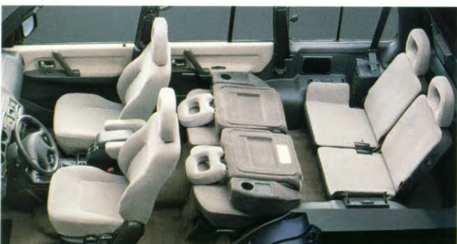
Stoelen op de tweede rij - U kunt de stoelen op de tweede rij onafhankelijk naar voren klappen. Dit heeft als voordeel dat ze gebruikt kunnen worden als tafeltjes voor passagiers op de derde rij.
