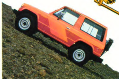
Klimmen is eenvoudig dank zij een superlage gearing bij een hoog koppel.
