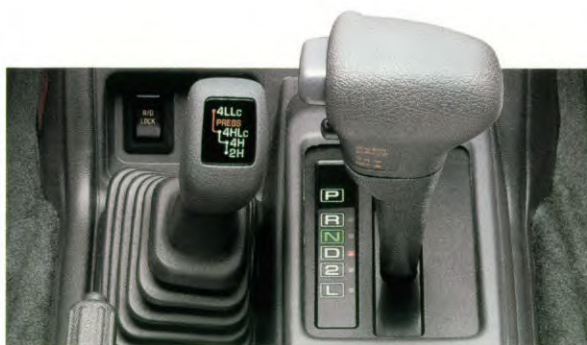
De schakelhendel voor het intelligente Super Select 4WD en de hendel van de automatische transmissie.
