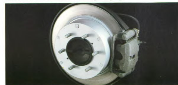
Een stevige dosis remkracht blijft van groot belang. Daarvoor zorgen schijfremmen met een diameter van 38 cm.
