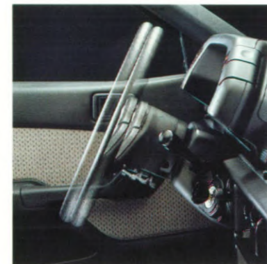
Het verstelbare stuur (voor-/achterwaarts en vertikaal) zorgt voor een optimale rijpositie (v.a. 1.3 GL).
