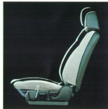
Met de vingertoppen te bedienen hendels voor zithoogte- en rugleuningverstelling op de bestuurdersstoel.
