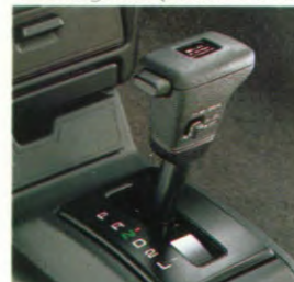
4-versnellingsautomaat met "zuinig of sportief" schakelaar.
