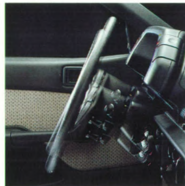
Het verstelbare stuur (voor-/achterwaarts en vertikaal) zorgt voor een optimale rijpositie (v.a. 1.3 GL).
