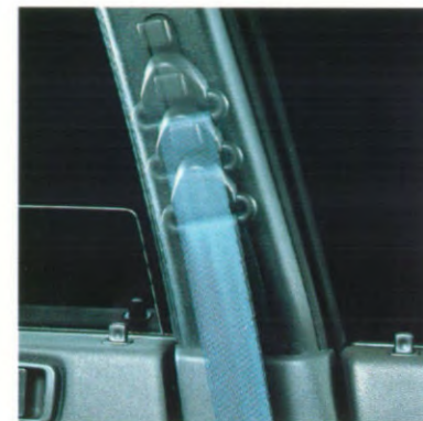
De veiligheidsgordels vóór (v.a. 1.3 GL) op de middenstijl zijn in hoogte verstelbaar (5 standen) voor ontspannen en ongehinderd autorijden.
