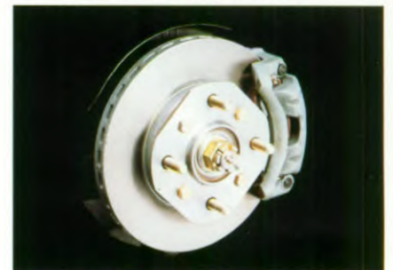
Mitsubishi heeft deze hatchback aan de voorzijde uitgerust met geventileerde schijfremmen. Een veilig, soepel en optimaal effectief remvermogen is het resultaat.
